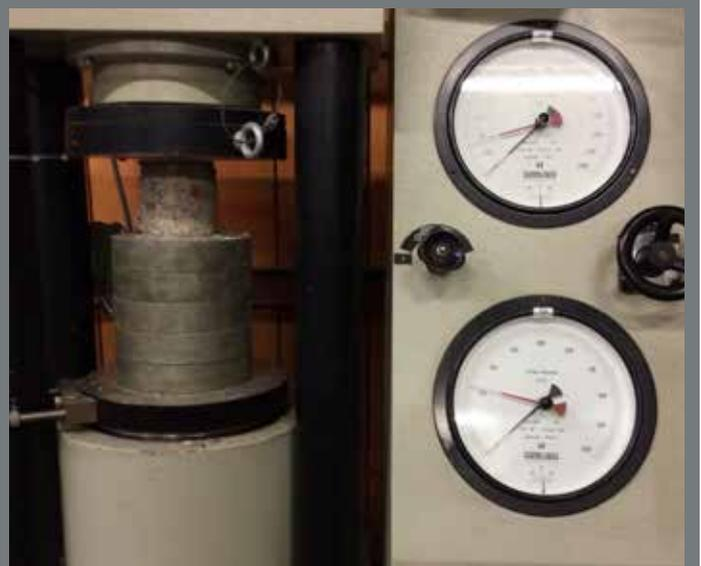
300-t-Druck-Prüfpresse zur Bestimmung der Druckfestigkeit (zerstörend)
