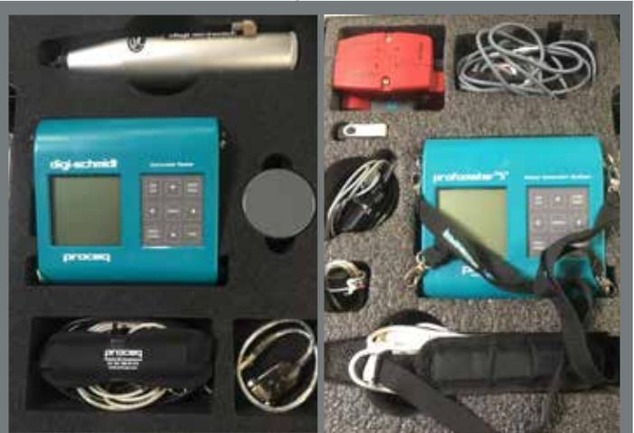
Zerstörungsfreie Bauwerksprüfung mit Betondeckungsmessgerät und digitalem Schmidthammer
